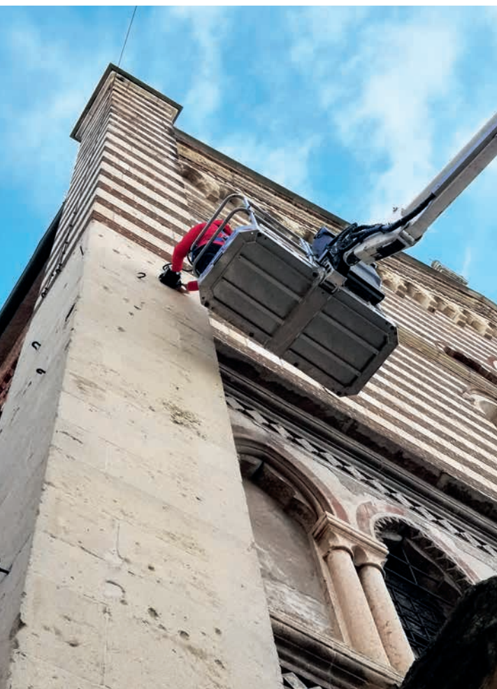
1. Acquisizione di una sezione georadar sulla facciata.
