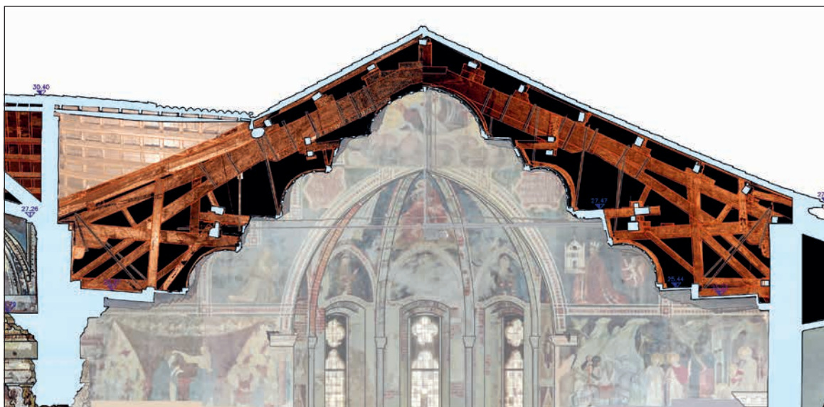
1. Sezione trasversale della copertura; si nota l'articolato reticolo di elementi lignei e metallici che compongono la struttura principale e la struttura di sostegno del controsoffitto a carena di nave.
