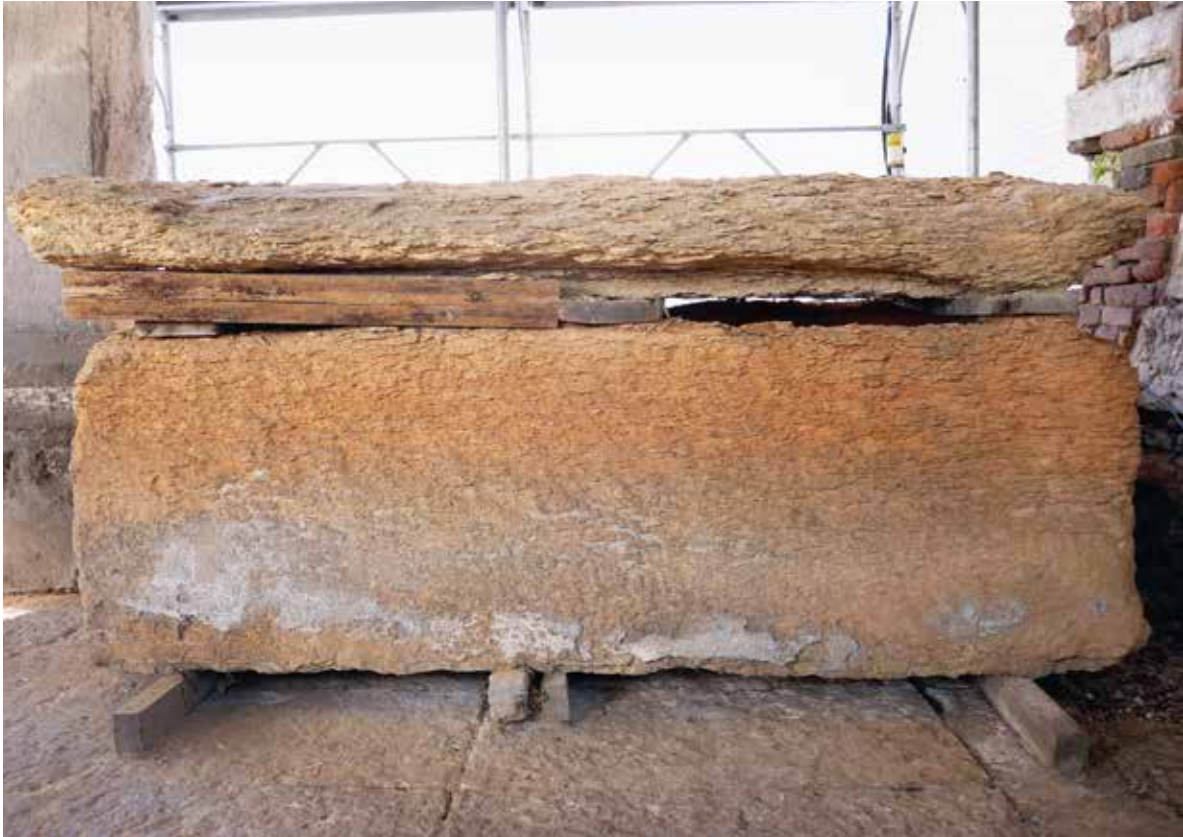
Fig. 7. Manifestazione dell'assorbimento capillare.
